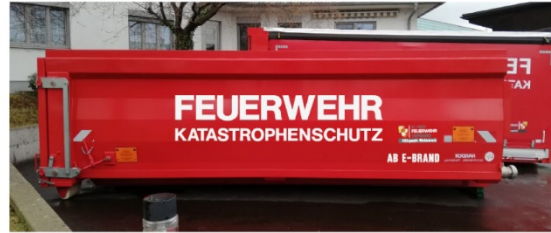
Hersteller: Container Trading s.r.o., SK-91701 Trnava Material: 3 mm HARDOX 450
