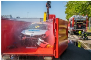
Boden- und Seitenbesprinklung
