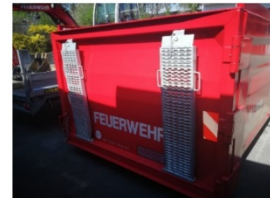
Rückwand, Schwenktür rechts öffnend, mit gehaltenen Auffahrrampen
